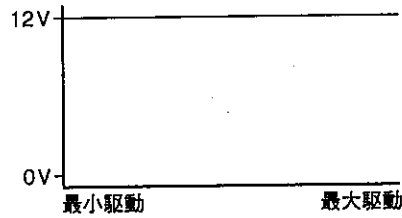
図3 CCW 駆動時の電圧特性 (図1のV 2 で測定)
